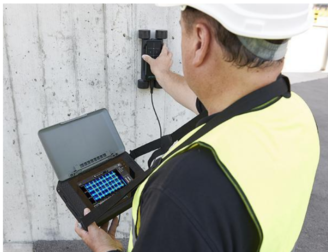
Skanim elektromagnetik i armaturës (cover-meter).
